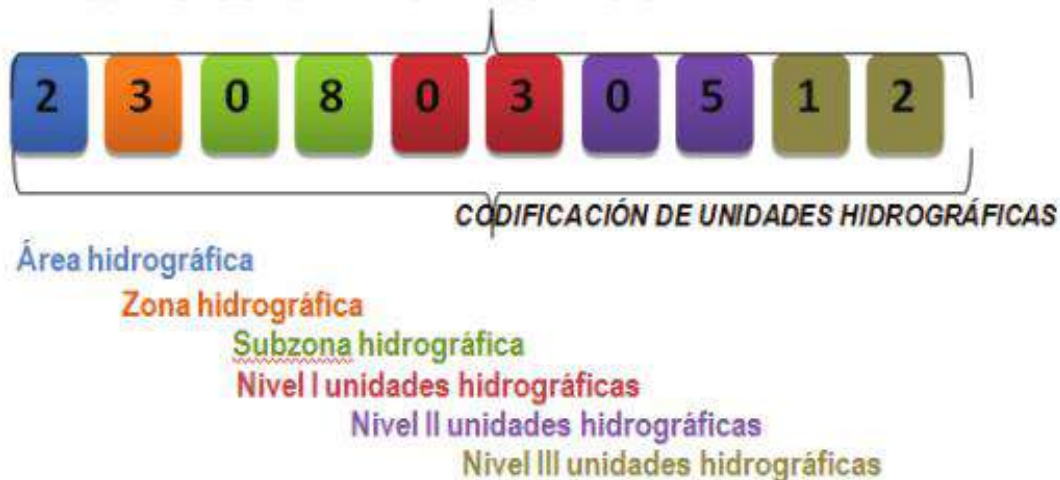
Figura 1. Sistema de codificación de unidades hidrográficas
